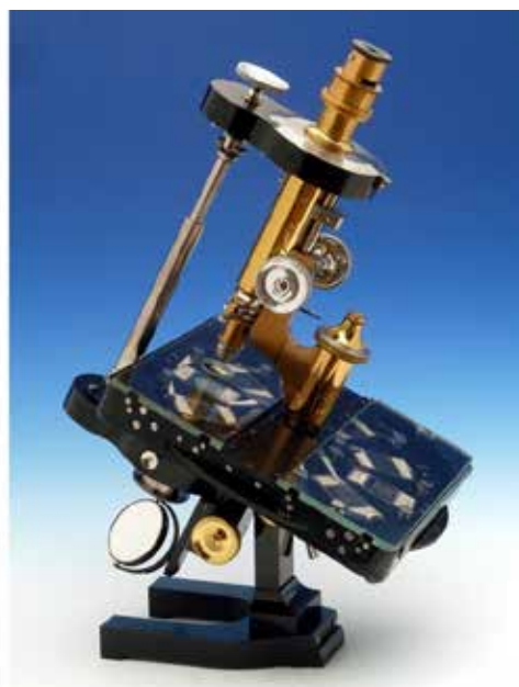
De demonstratiemicroscop van Kaiser/Leitz. Afbeelding uit Kaiser, E. (1913): Über ein Demonstrationsmikroskop für den mineralogischen und petrographischen Unterricht . Zeitschrift für Kristallographie, 53 , 397-403, en het hier beschreven instrument.
